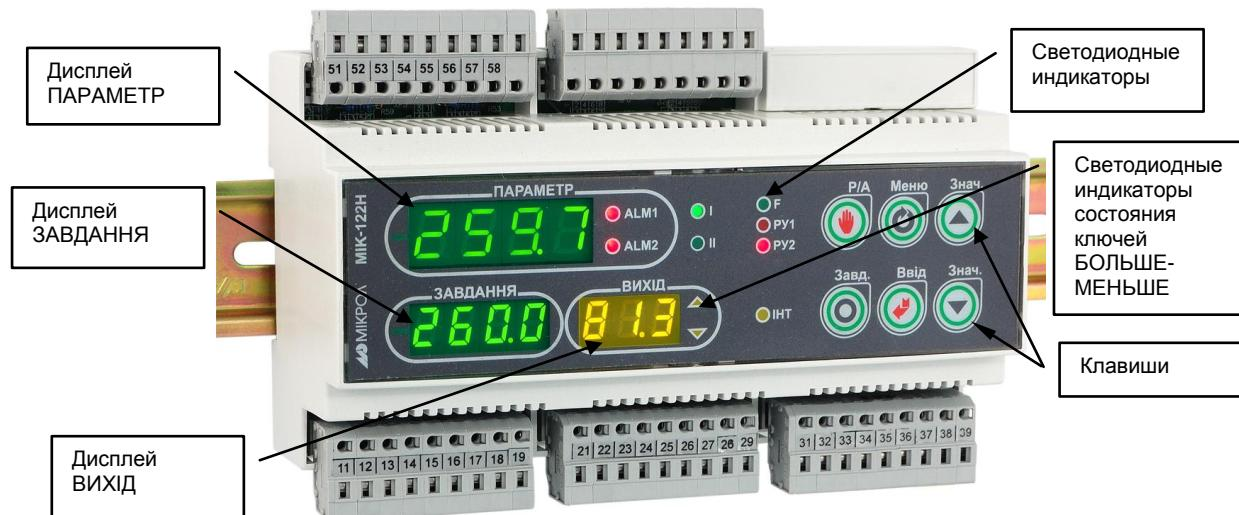
Рисунок 3.1 - Внешний вид передней панели регулятора МИК-122Н
