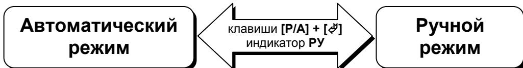
Рисунок 4.1 – Режимы работы регулятора МИК-122Н
