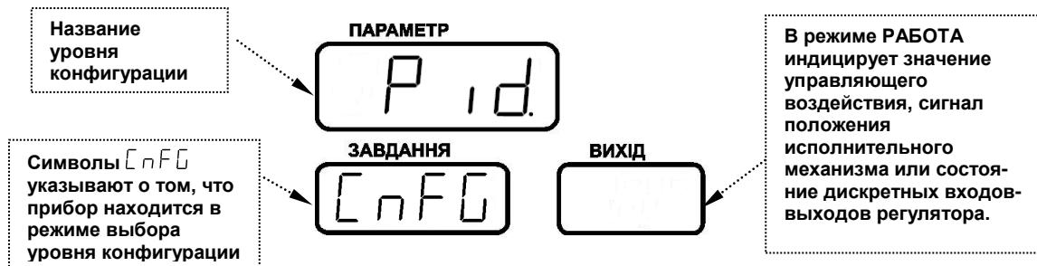
Рисунок 4.3 - Индикация значения параметров конфигурации и их номеров.
