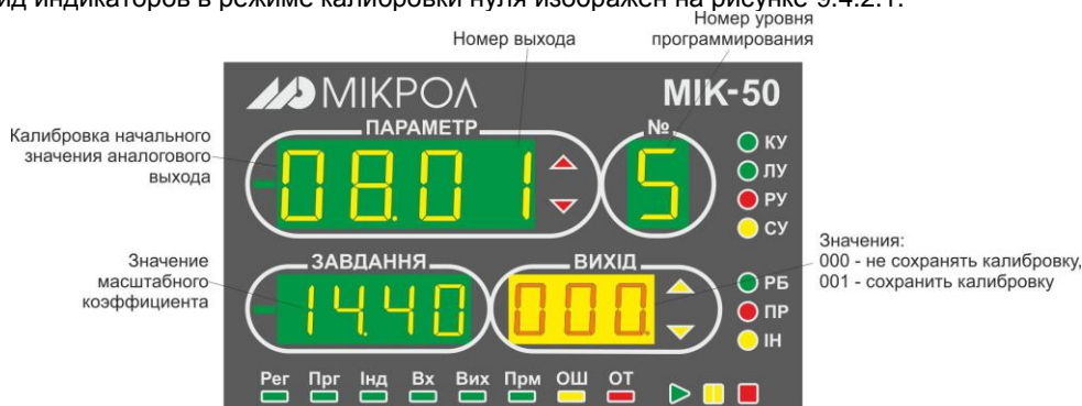
Рисунок 9.4.2.1 - Внешний вид индикаторов при калибровке начального значения аналогового выхода
