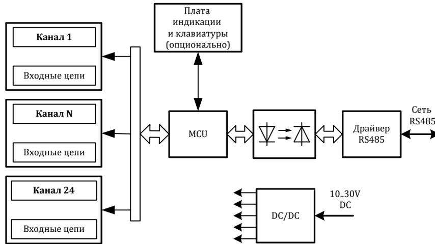
Питание устройства осуществляется от источника постоянного напряжения в диапазоне от 10В до 30В. Потребляемая мощность устройства не более 4,0Вт.
