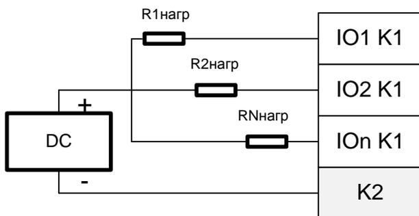
Подключение линий дискретного вывода типа «Открытый коллектор»
