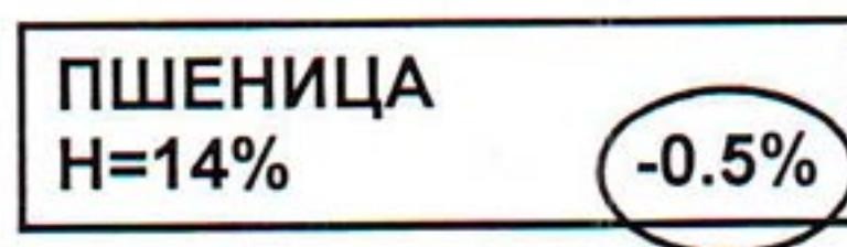
Кнопками , установите желаемую поправку. Одновременно с внесением поправки слева меняется значение влажности, уже скорректированное. Установив желаемое значение, коротко жмите «Ввод», и значение поправки исчезнет с дисплея. Форма калибровочной кривой при внесении поправки не изменяется. Происходит только параллельный перенос характеристики «вниз» -«вверх». Поправка для каждого из 99 каналов своя и независима. Пределы регулировки + - 5% с шагом 0,1%.
