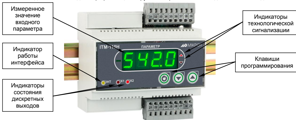
Рисунок 3.1 - Внешний вид индикатора ИТМ-110Н
