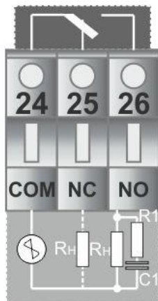
Рисунок Б.3 – Схема подключения индуктивной нагрузки к механическому реле
