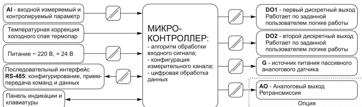
Рисунок 3.2 - Структурная схема индикатора ИТМ-110Н
