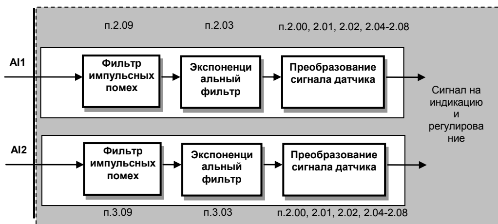
Рисунок В.2 – Функциональная схема программного преобразования входных аналоговых сигналов
