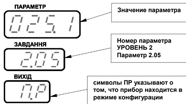
Рисунок 6.3 – Индикация значения параметров конфигурации и их номеров.
