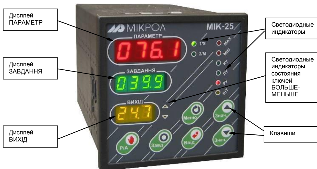
Рисунок 5.1 – Внешний вид передней панели регулятора МИК-25
