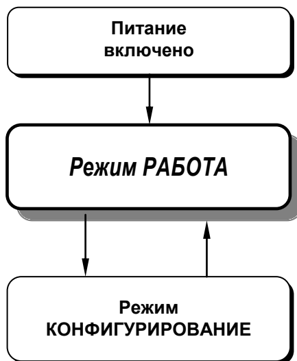
Рисунок 4.6.1 – Диаграмма режимов работы и настройки преобразователя ПНС-12
